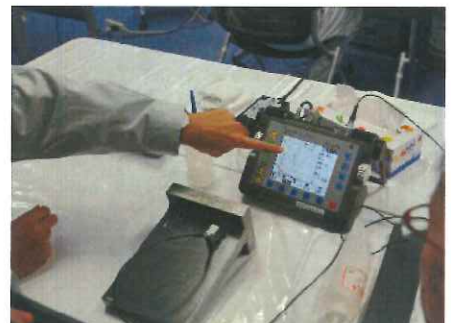
超音波探傷検査装置
