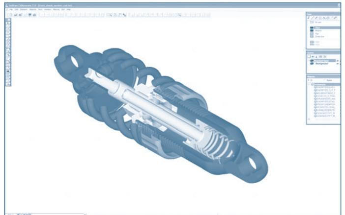
3 次元 CAD データを操作して、1 つの部品の詳細または複数のコンポーネントを示す断面図を作成できます。
