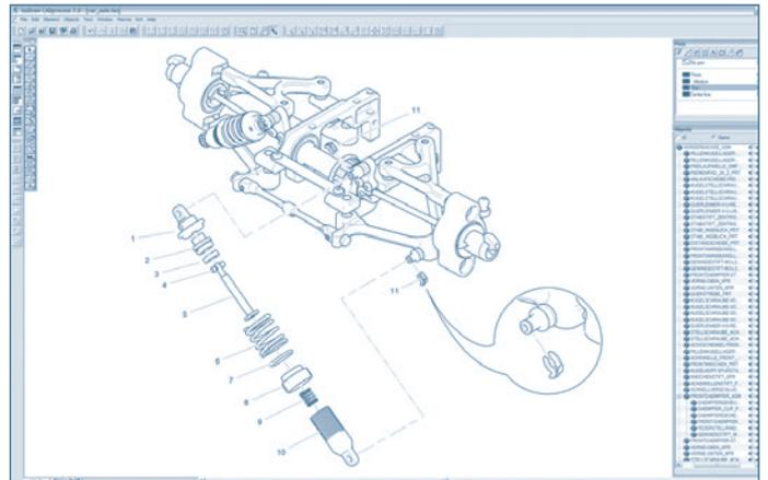
元の設計データとの情報連携性を維持して CAD からイラストレーションを作成できます。イラストレーションを使うと、サービス手順をわかりやすく明確に伝えることができます。
