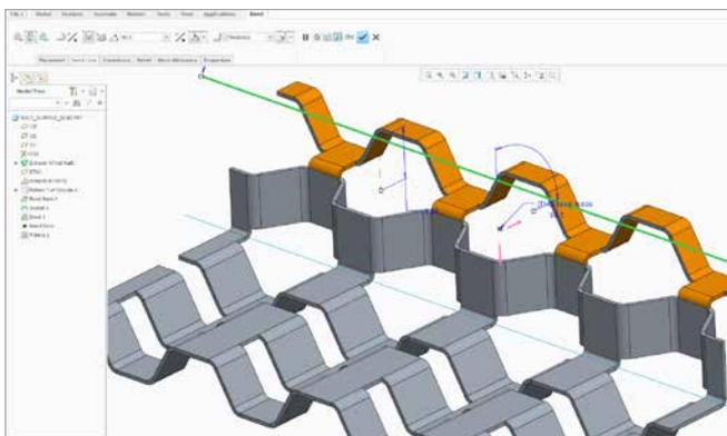
ベンド リリースの適用、シートメタルのリップの作成、同一平面ジオメトリのベンドなどを自動的に行う機能を使用して、板金ジオメトリを作成できます。
